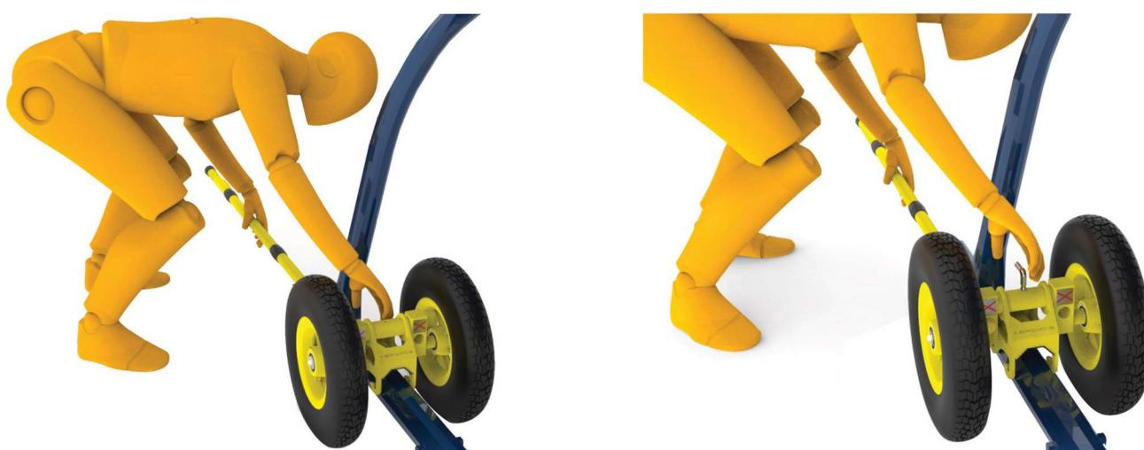
Antes de remover a barra de alavancas, certifique que o pino esteja INSTALADO no furo de travamento até o batente, como mostrado abaixo. Remova a barra da alavancas apenas depois de o pino ser posicionado no furo trava.
