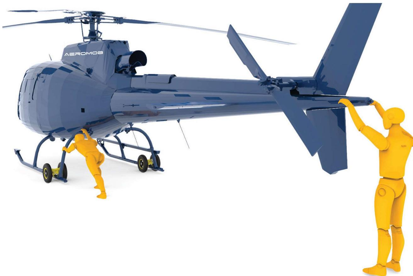
Os operadores só poderão exercer a força de equilíbrio no cone de cauda em ponto aprovado pelo fabricante da aeronave, assim como a força exercida ao empurrar e puxar o helicóptero. Após a movimentação da aeronave até o local desejado, o operador da cauda deverá baixar o nariz do helicóptero lentamente até o contato com parte frontal dos esquis com o solo.
