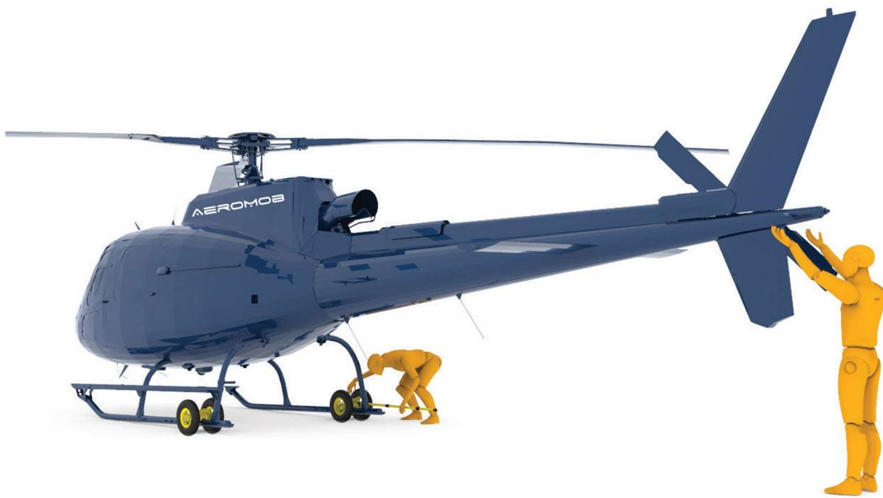
Segurando a barra alinhada com os esquis, remove o pino do furo de trava e armazena o pino no suporte.
