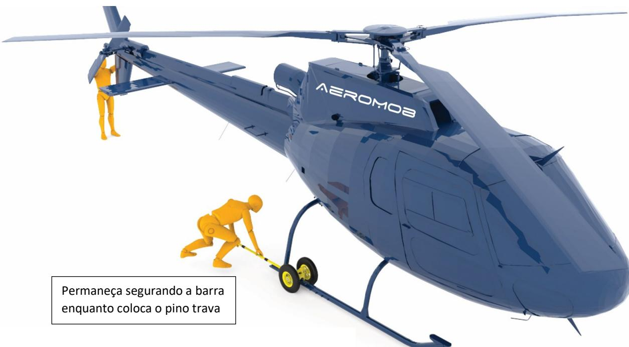
Segurando a barra com uma mão, retire o pino de suporte do encaixe com a outra mão e coloque-o no furo trava.
