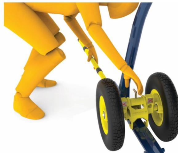
Antes de remover a barra de alavanca, certifique que o pino esteja INSTALADO no furo de trava até o batente, como mostrado abaixo. Remova a barra da alavanca apenas depois de o pino ser posicionado no furo trava.
