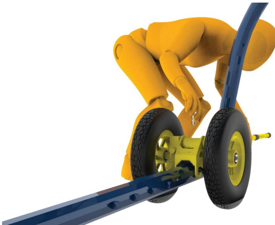
Segurando a barra pelo recartilhado e ficando ATRÁS da barra, comece a desalavancar, colocando o seu pé mais próximo do esqui em cima do pneu do HELIMOB. Isso garantirá que seu pé não fique embaixo do esqui, e facilitará muito a desalavancagem, pois você utilizará o peso do seu corpo para segurar a barra, reduzindo o esforço físico necessário para desalavancagem.
