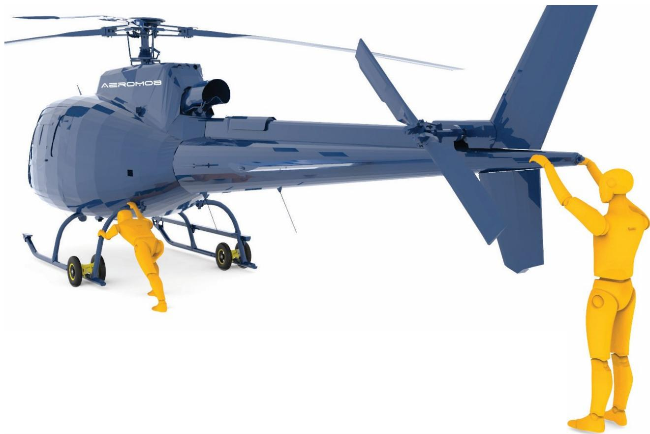
Os operadores só poderão exercer a força de equilíbrio no cone de cauda em ponto aprovado pelo fabricante da aeronave, assim como a força exercida ao empurrar e puxar o helicóptero. Após a
