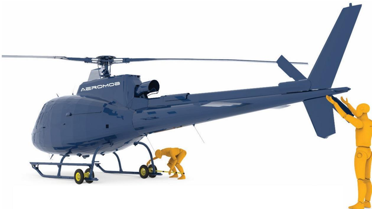
Segurando a barra alinhada com os esquis, remove o pino do furo de trava e armazena o pino no suporte.
